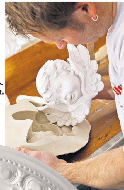
**Stuck kann auch gegossen werden, dafür wird eine Negativform erstellt.**
